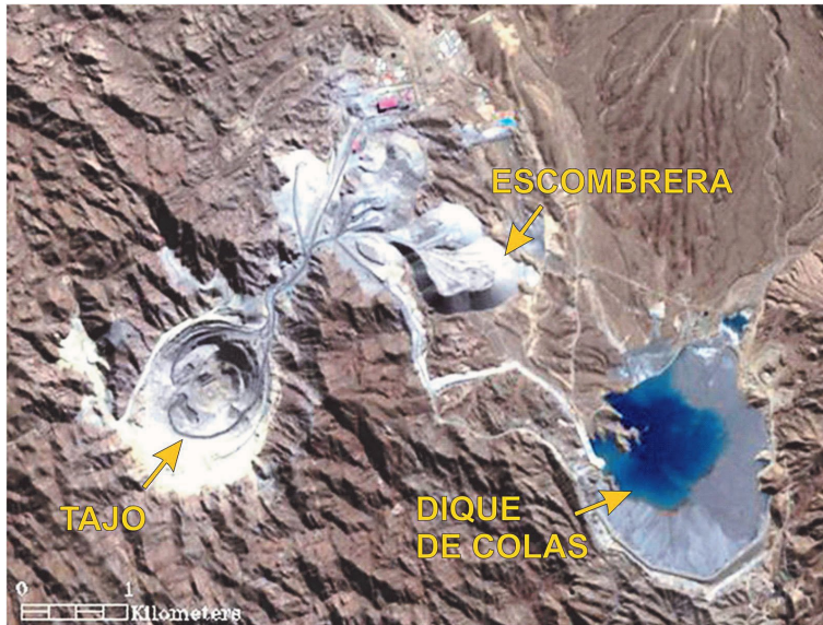
Figura 6 a: Megaminería en La Alumbraera (Catamarca, Argentina), con sus tres sitios principales de impacto (mega minería a cielo abierto-contamina.blogspot.com)
