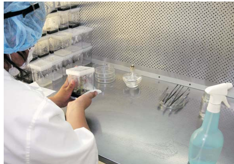
Flujo laminar que proporciona un área estéril
