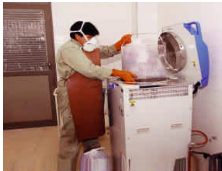
Sistema de autoclave utilizado en el Hospital Albina Patiño
